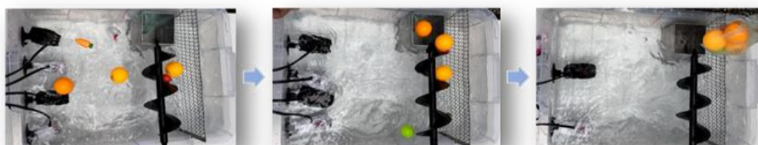
圖 14 垃圾流向示意圖 圖 15 螺旋帶動垃圾示意圖 圖 16 垃圾打包拿取示意圖
